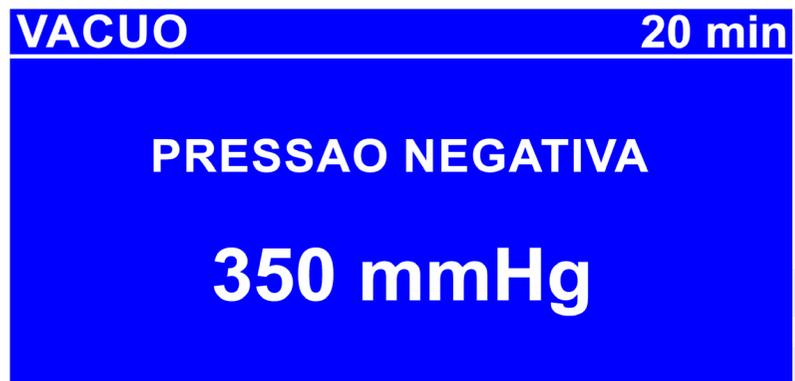
Ao término do tempo programado a pressão negativa será interrompida e o equipamento emitirá um sinal sonoro que deverá ser desligado através da tecla **STOP**.
