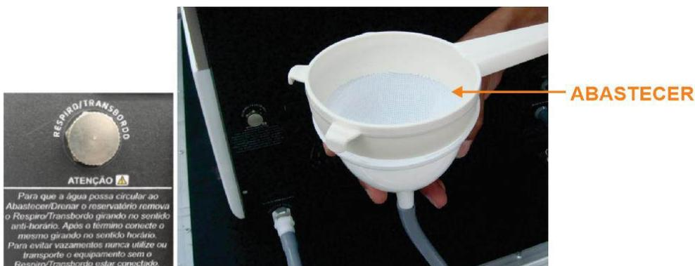
☑ Para retirar a água do reservatório primeiro remova o Respiro/Transbordo, em seguida conecte a mangueira e retire o funil e direcione a mangueira a um recipiente, deixe-o a um nível inferior ao do reservatório e aguarde que toda a água seja retirada. Após drenar coloque de volta o Respiro/Transbordo.
