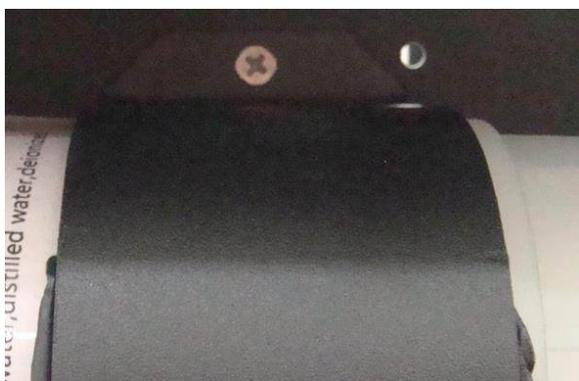
*Fixação superior do suporte do filtro de água*
