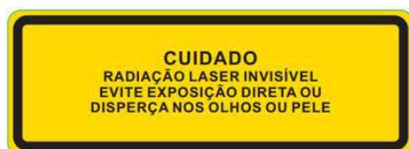
→ Etiqueta de aviso de radiação LASER invisível (IEC 60825-1 5.10 *Warning for invisible laser radiation*).
