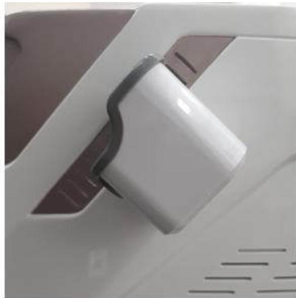
3) Conecte o cabo do aplicador na parte frontal do equipamento, na saída definida como “LASER OUTPUT” firmemente até observar um encaixe completo dos contatos elétricos e engates rápidos.
