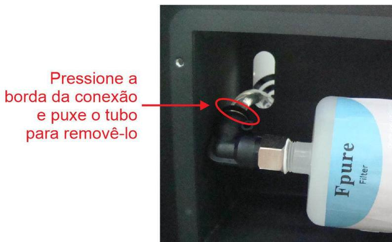
4 – Para inserir o novo filtro de água basta pressionar os tubos plásticos de encontro as conexões instantâneas já inseridas no item.
