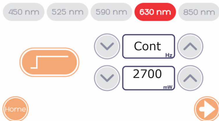
Imagem 48. Tela de seleção de comprimento de onda e modo de emissão de energia: contínuo ou pulsado.
