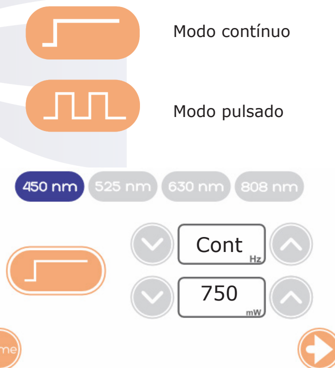
Imagem 53. Tela de seleção de comprimento de onda e modo de emissão de energia: contínuo ou pulsado.
